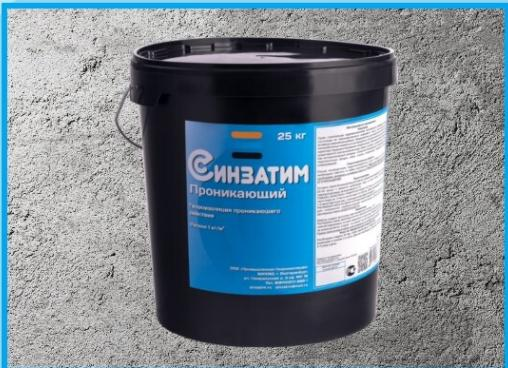
**Описание:** Сухая строительная гидроизоляционная проникающая капиллярная смесь, предназначенная для гидроизоляции бетонных и железобетонных элементов конструкций за счёт заполнения пор капиллярного характера трудно растворимыми соединениями.
