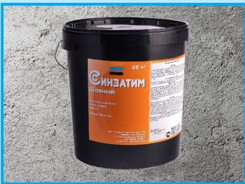
**Описание:** Сухая строительная гидроизоляционная поверхностная смесь, предназначенная для гидроизоляции статичных трещин, швов, стыков, вводов коммуникаций, примыканий, за счёт высокой водонепроницаемости и отсутствия усадки. Обладает высокой адгезией к бетону.
