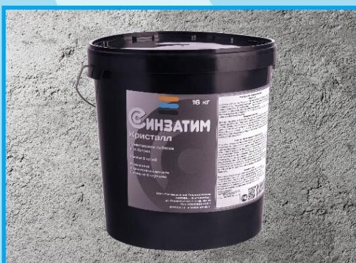
**Описание:** Химическая добавка предназначена для обеспечения водонепроницаемости, повышения морозостойкости, и коррозионной стойкости бетона за счет химического влияния на процессы гидратации портландцемента.
